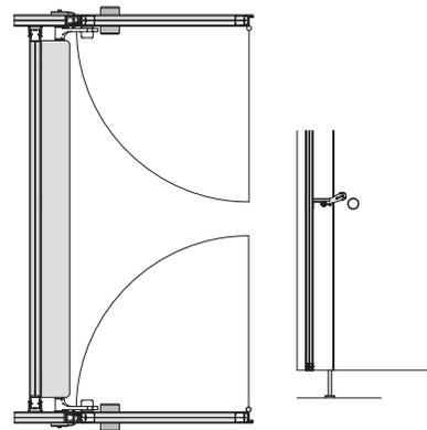
Synchrone Verriegelung der Wechselkabine mittels Hebelzentralverriegelung.
