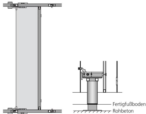
Die Wechselkabine kann mittels Unterbankzentralverriegelung synchron verriegelt werden. Alternativ steht die Verriegelung mittels Hebelzentralverriegelung zur Auswahl.
