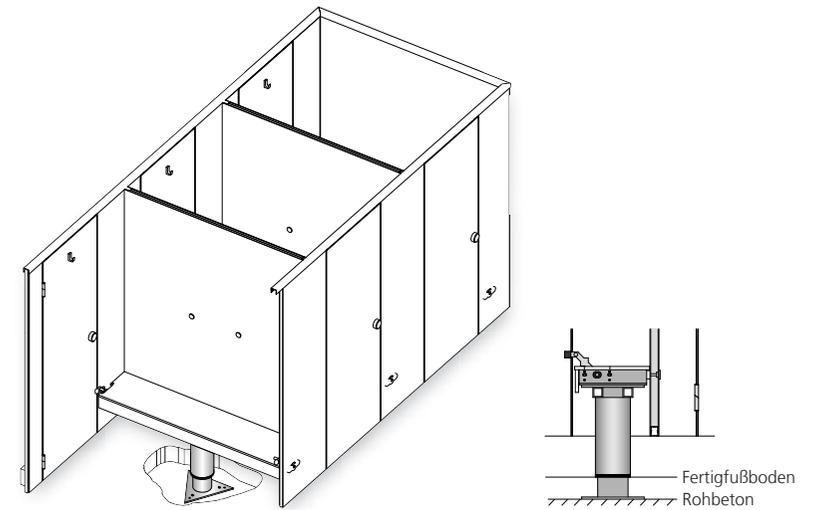
Der optionale zentrale Mittelfuß unter der Kabinensitzbank wird schon auf dem Rohboden verankert. Dadurch kann die komplette Kabine auf einem Fuß aufgeständert werden und Füße in der Front weitgehend überflüssig.
