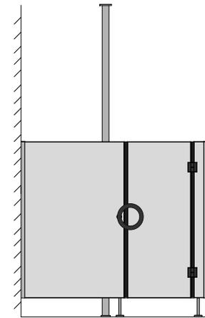
Bei breiten Frontteilen kann zur Stabilisierung ein Aluminiumrohr, dass bis zur Decke geführt wird, erforderlich werden.
