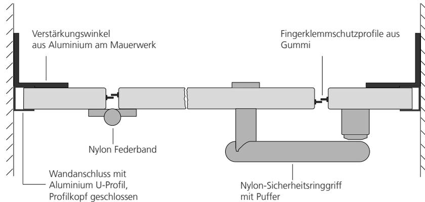
Stabilisierungslösung bei breiten Fronten
